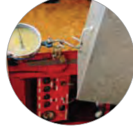
Dichtebestimmung mit Hilfe des Prüfcorbes
